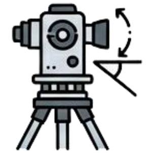
أ- جهاز الثيودوليت لقياس الزاوية العمودية.
