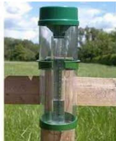
صورة: لجهاز قياس المطر.
