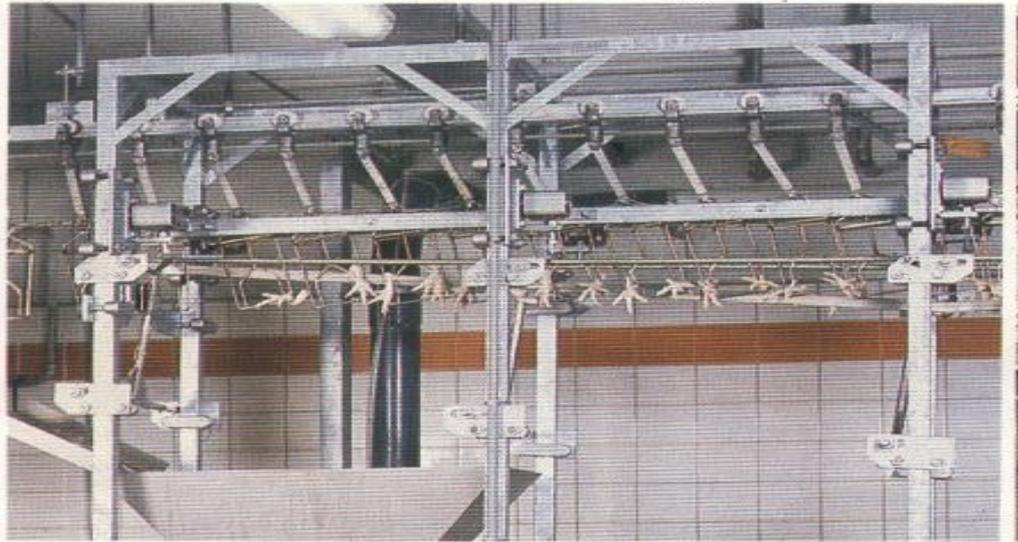
الشكل رقم (26) جهاز قص الارجل
