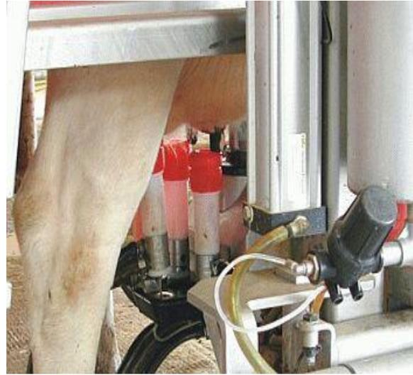
شكل ( 9 - 26 ) التركيب الميكانيكي ووحدة الأشعة الليزرية حيث تقوم بتثبيت كؤوس الحلمات
