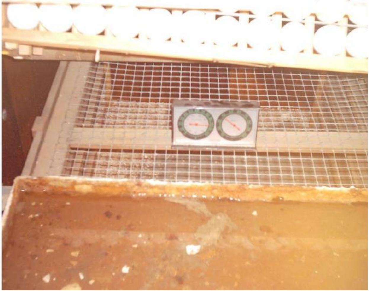
شكل رقم ( 2 ) جهاز قياس الحرارة والرطوبة
