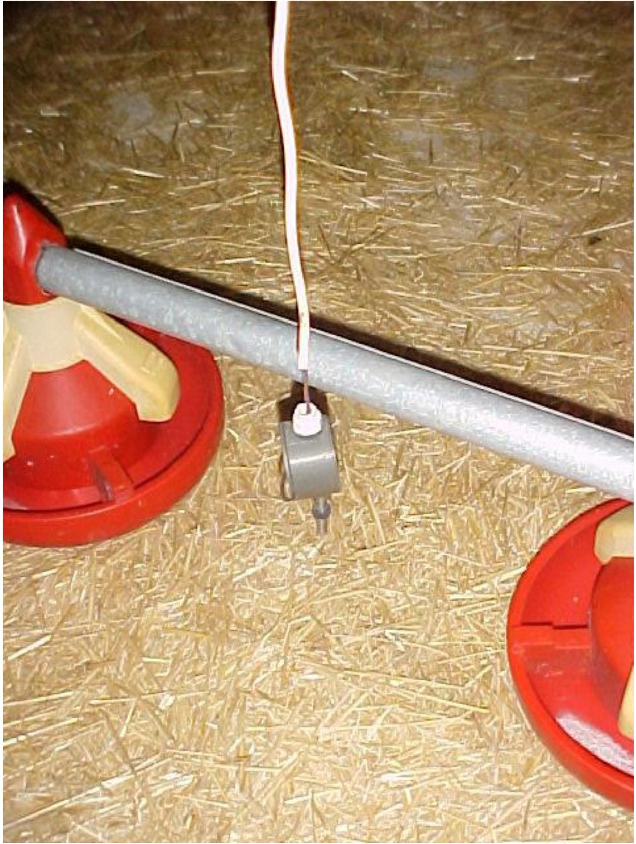
شكل (5) جهاز قياس درجة الحرارة داخل الحظيرة
