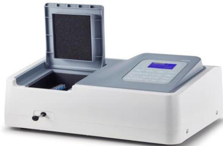
جهاز المطياف الضوئي Spectrophotometer System ، تستعمل طريقة الامتصاص عند الطول الموجي ٢٦٠ nm لقياس كمية الدنا او الرنا او كليهما في محلاليها وهي طريقة سريعة وسهلة ودقيقة لقياس كمية الأحماض النووية.
