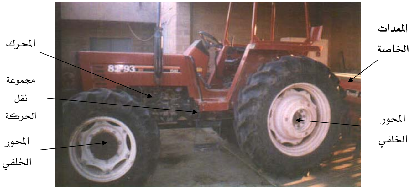
شكل (٣-٣) الأجزاء الرئيسية للجرار الزراعي
