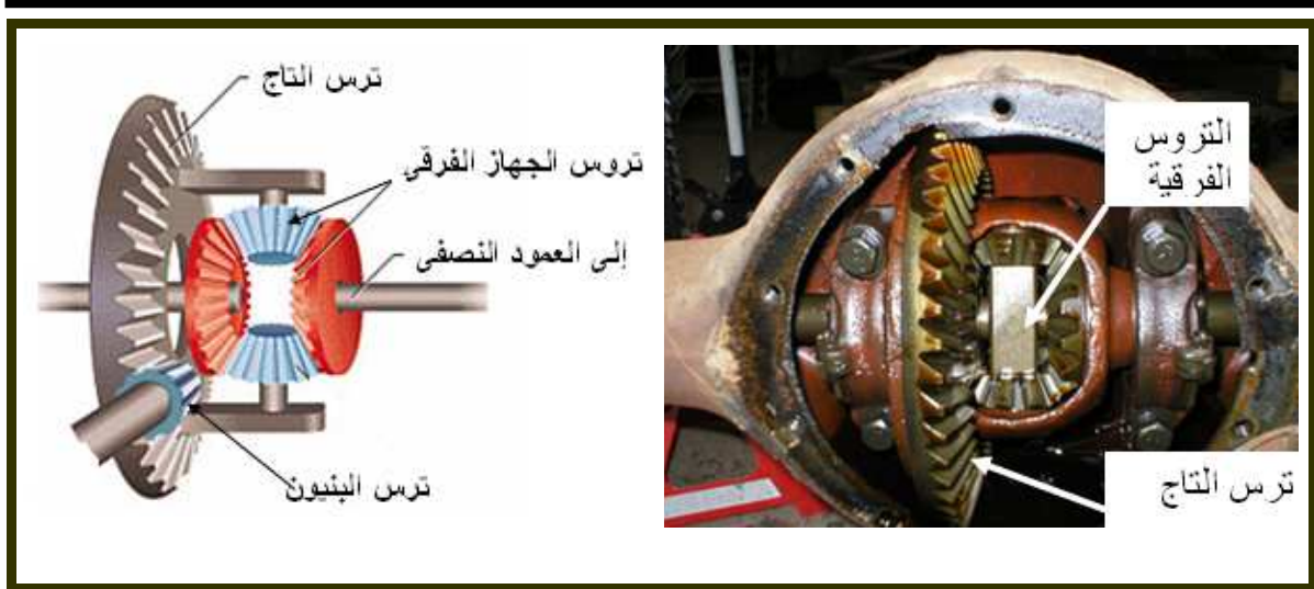
شكل (١٠): الأجزاء التى يتكون منها الجهاز العمودى والجهاز الفرقي
