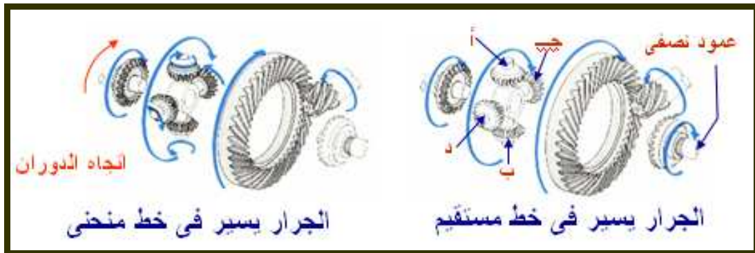
شكل (١١): إتجاه الحركة في الجهاز العمودى والجهاز الفرقي أثناء سير الجرار
