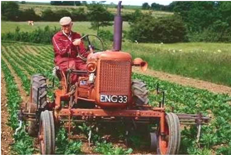
الشكل رقم ١/٤. جرار محاصيل الصفوف بأربع عجلات
