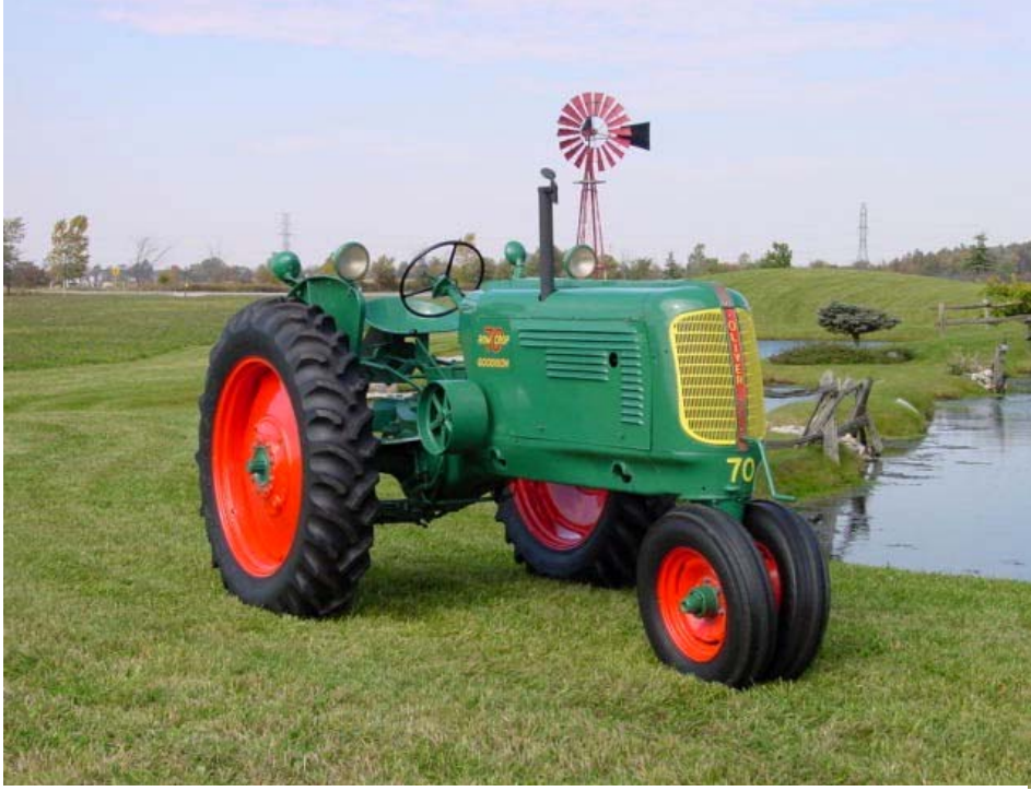
الشكل رقم ١/٣. جرار محاصيل الصفوف بثلاث عجلات
