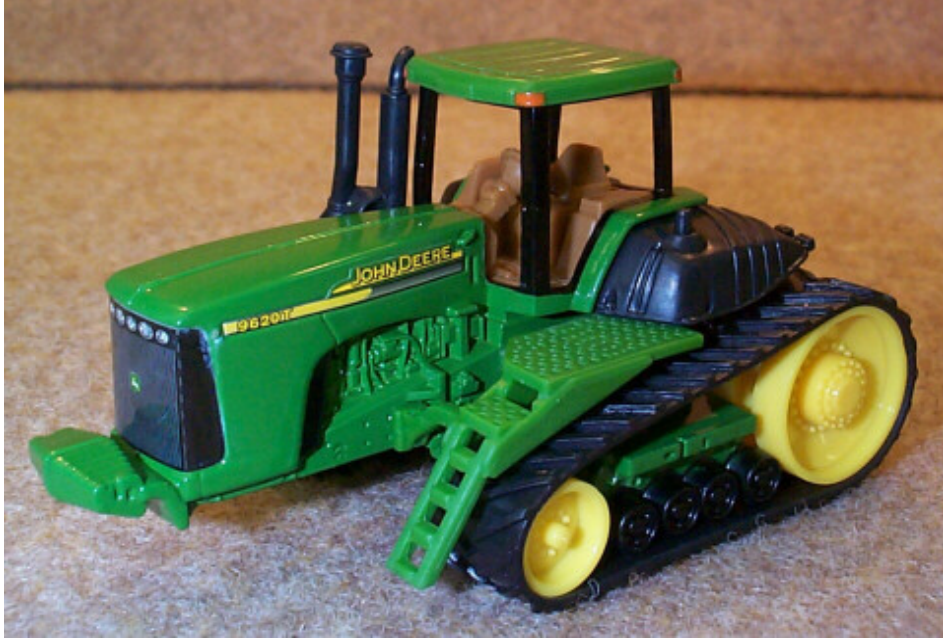
الشكل رقم ١/٧. جرار بكتينة مطاطية
