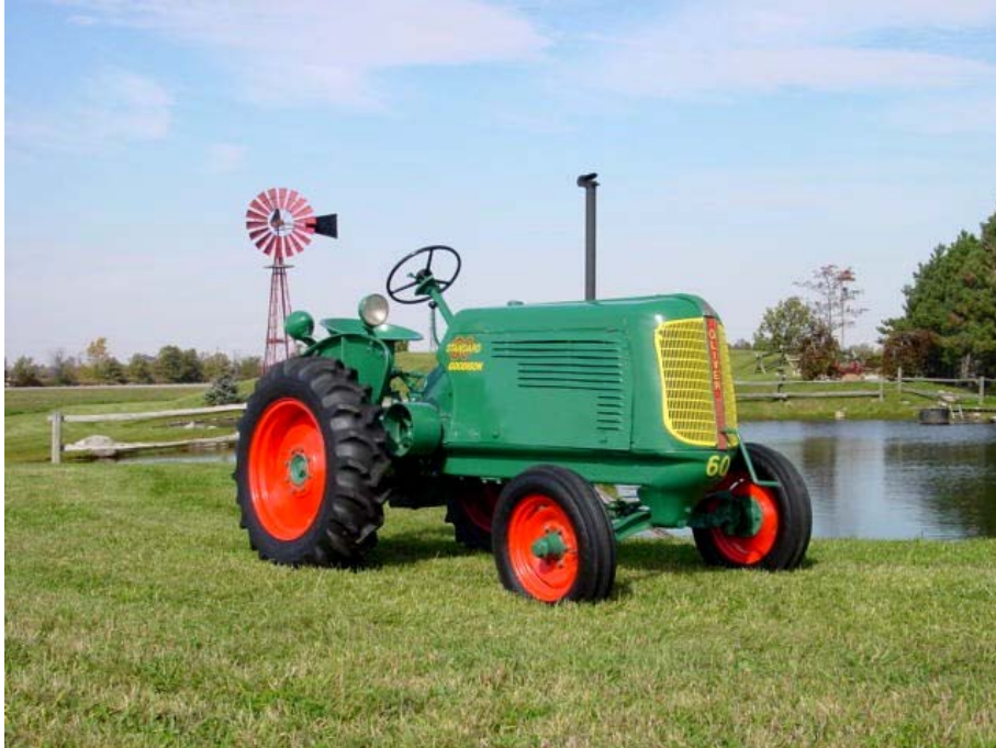
الشكل رقم ١/٨ جرار ذو دفع ثنائي ( العجلات الأمامية ملساء ولا يوجد عليها بروزات )
