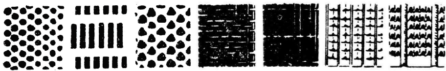
شكل ١٩٨ : انواع مختلفة من غراييل التنظيف المختلفة في شكل واقطار فتحاتها
