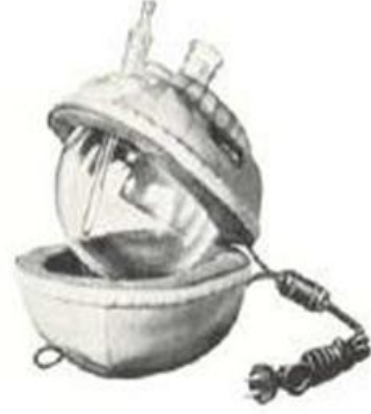
مغطف تسخين كهربائي
