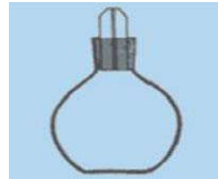
قنينة الكثافة Density bottle او البيكnomيتر Pycnometer
