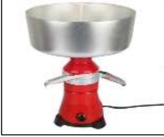
وذلك باستخدام جهاز الفراز Separator الذي يعتمد مبدأ الطرد المركزي حيث يدخل الحليب فيه لنحصل على منتوجين هما الحليب الفرز Skim milk والقشطة Cream، تستعمل هذه العملية لصناعة القشطة كمنتوج نهائي أو كخطوة أولية في صناعة الزبد، وتستخدم لأغراض تعديل نسبة الدهن في الحليب الخام.
