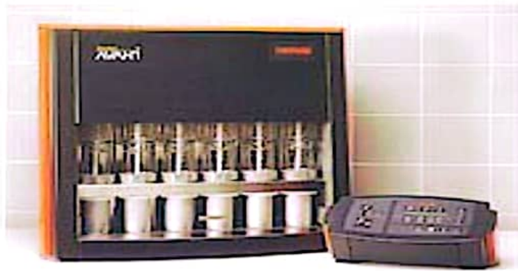
شكل (22) جهاز سوكسلت لتقدير الدهن في الأغذية.
