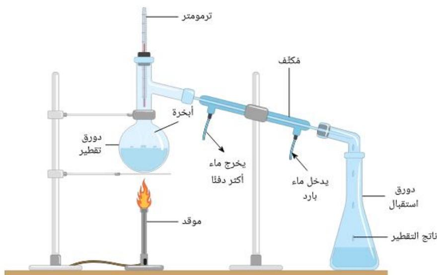
يجب أن يكون رأس الترمومتر أمام فتحة المُكثِّف مباشرة. وهذا يعني أن قراءة درجة الحرارة ستكون انعكاسًا دقيقًا لدرجة حرارة البخار قبل دخوله مباشرةً في المُكثِّف (وليس دورق التقطير، الذي قد يكون أكثر سخونة قليلًا).
