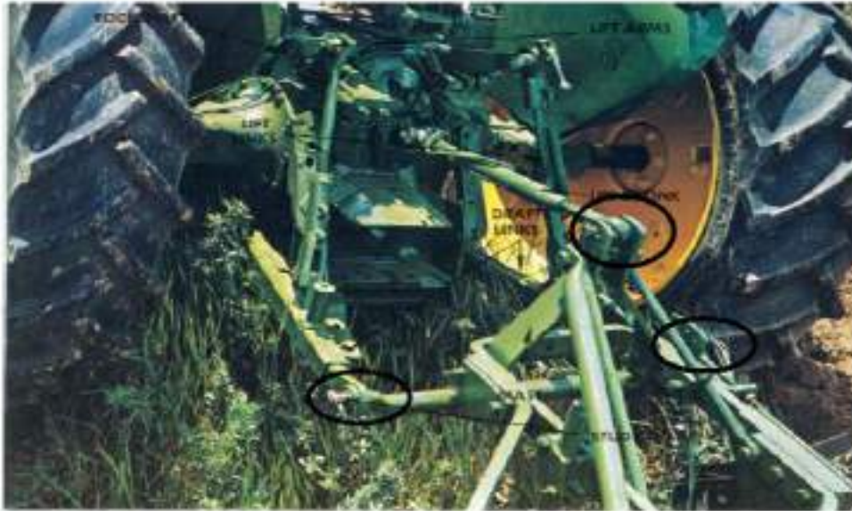
شكل (7- 9) نقاط الشبك الثلاث والأجزاء المكونة لجهاز رفع وخفض الآلات الزراعية
