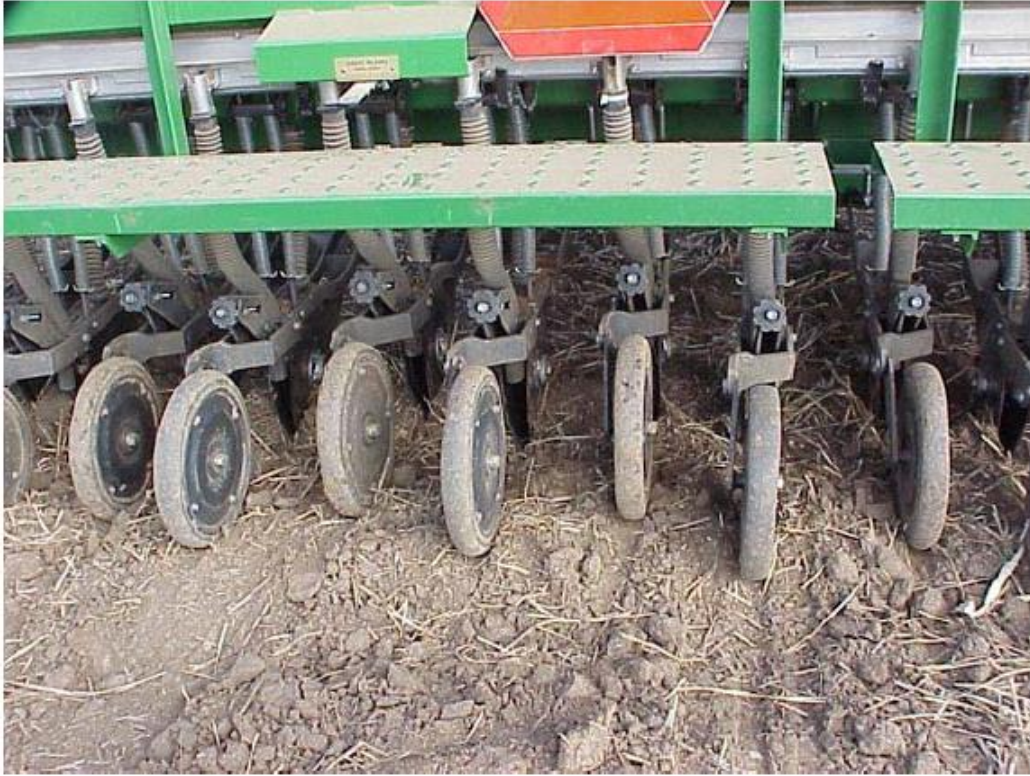
الشكل رقم ٣/١٠. استخدام العجلات البلاستيكية في تغطية البذور
