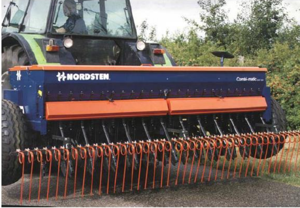
الشكل رقم ٣/١١. استخدام الأمشاط الزنبركية في تغطية البذور
