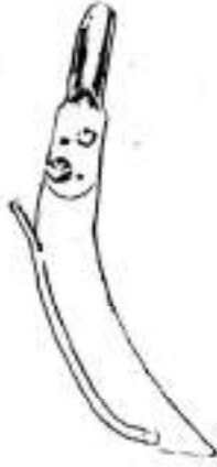
شكل ( ٧ - ١٠ ) نموذج من الاسلحة الملائمة مع معدات التسميد بالاسمدة السائلة والغازية
